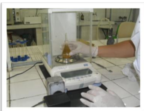
Pesagem cola de contato com picnômetro
