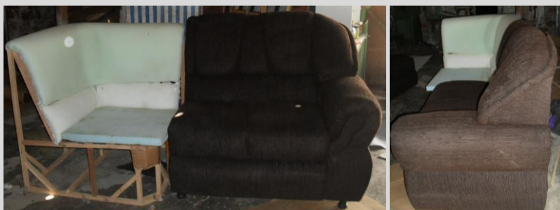
(a) Estrutura de madeira e espuma de estofamento de sofá da Empresa F versus qualidade percebida da peça acabada pelo usuário-consumidor
