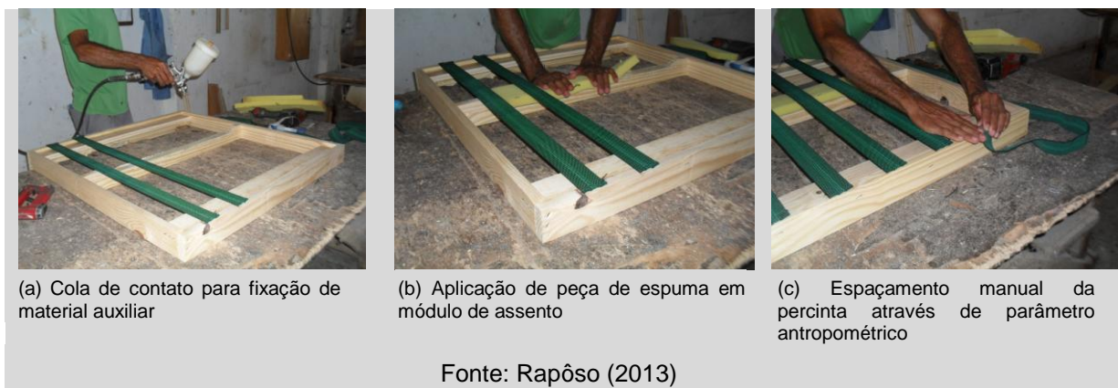
Figura 70 – Procedimentos de aplicação de percinta em módulo de assento
