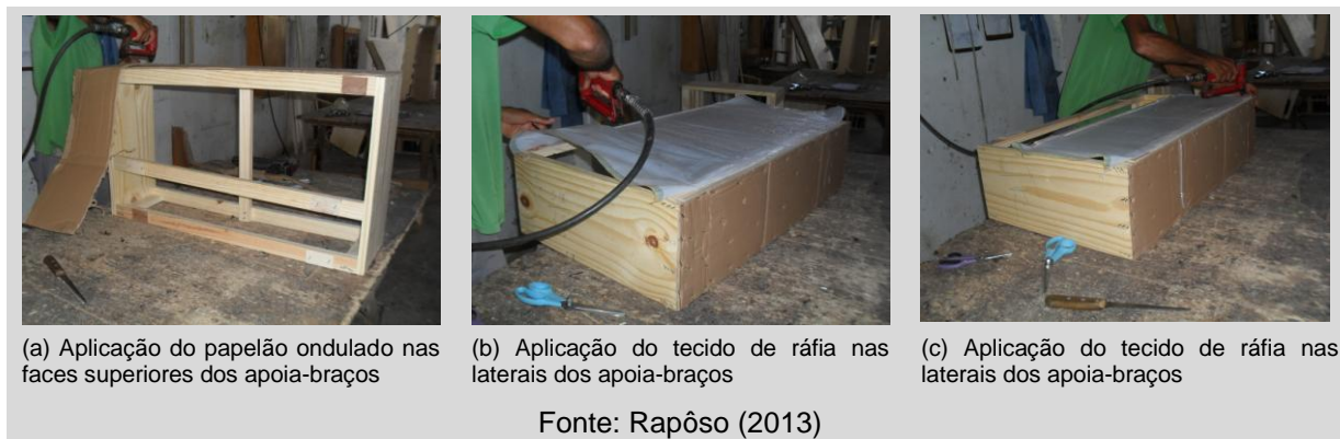
Figura 74 – Aplicação de planos de suporte nos módulos B e C
