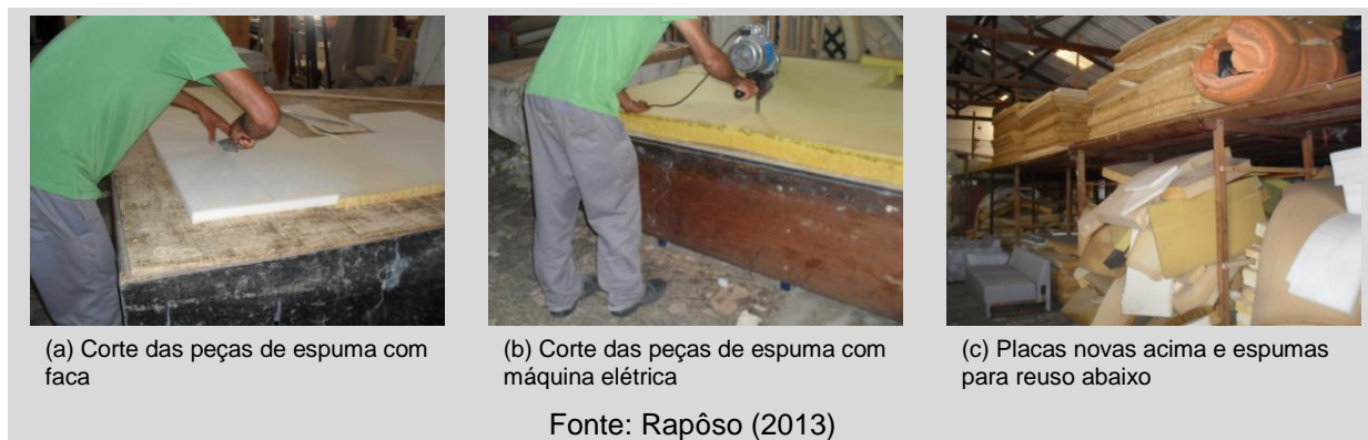
Figura 77 – Instrumentos de corte e área de armazenamento das espumas
