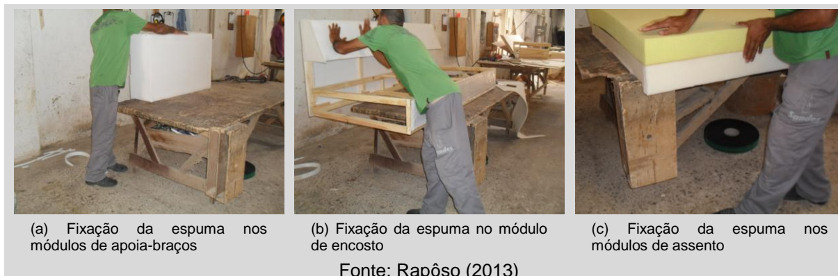
Figura 79 – Colagem da espuma nas superfícies de estofamento
