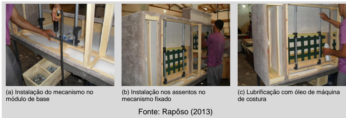
Figura 96 – Instalação do mecanismo retrátil nos módulos do sofá
