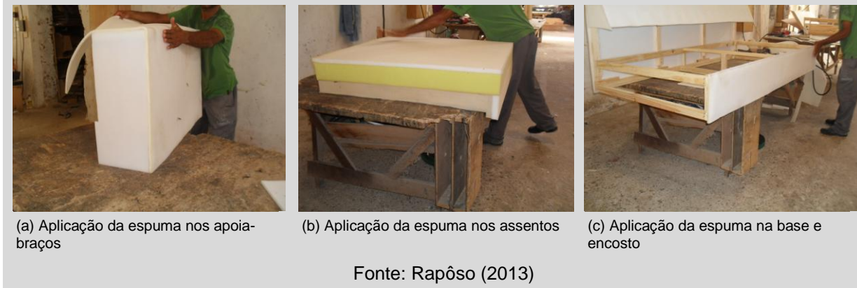
Figura 80 – Aplicação das peças de espuma nos módulos do sofá
