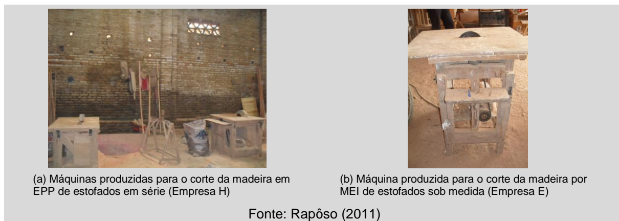
Figura 32 – Máquinas produzidas pelas estofadoras para corte da madeira
