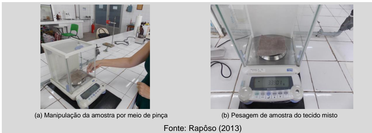
Figura 84 – Pesagem amostra de tecido misto
