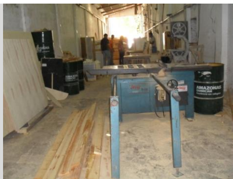
(a) Setor 1: Estrutura e Percinta – área de corte da madeira, montagem da grade e aplicação da percinta, papelão e manta de ráfia
