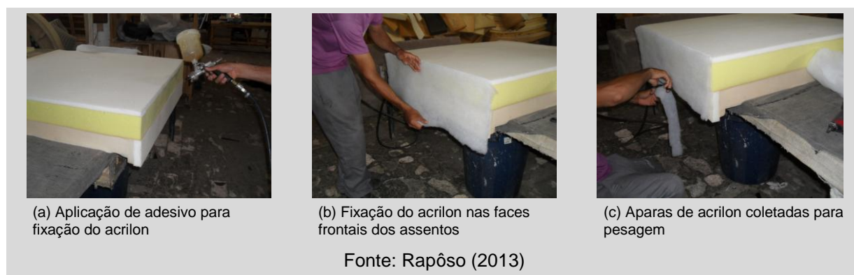
Figura 91 – Aplicação de manta acrílica nos módulos de assentos
