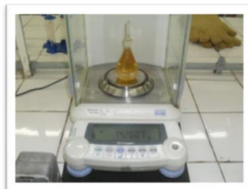
Pesagem cola de contato com picnômetro
