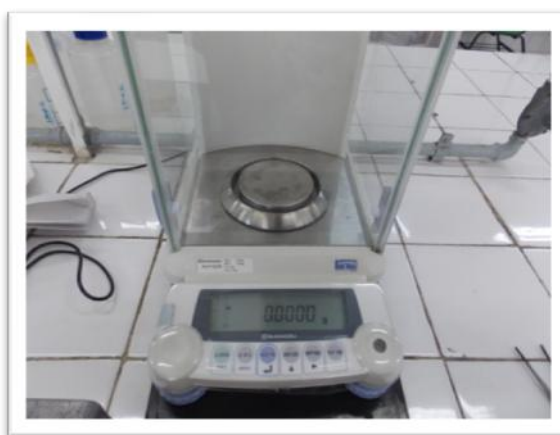
Figura 14: Balança analítica eletrônica
